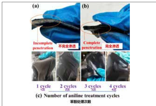
图5 离子液体(IL)辅助苯胺原位聚合制造导电和阻燃皮革
